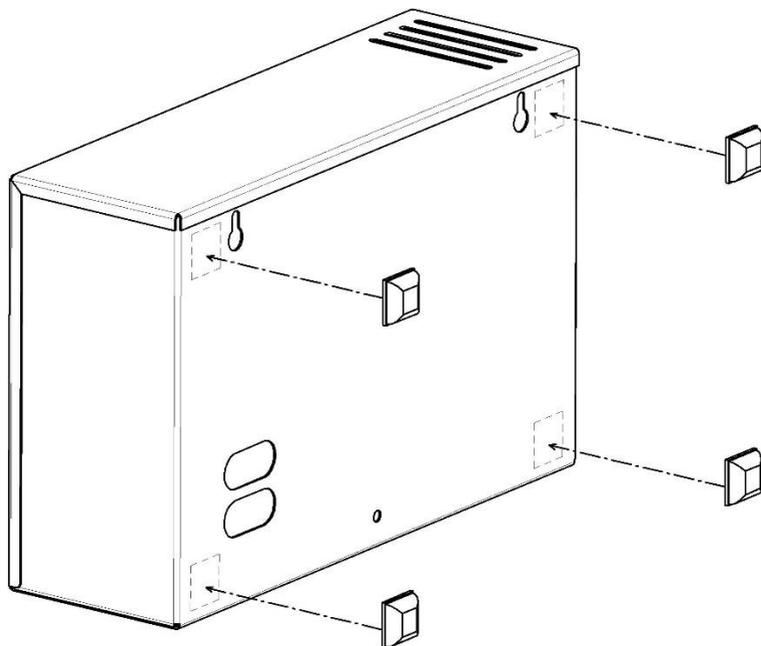
2) Закрепите источник на вертикальной поверхности используя штатные отверстия, предварительно протянув провода во вводные отверстия:
