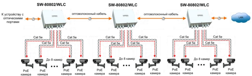
Рис.6 Каскадная схема подключения коммутатора SW-80802/WLC,
