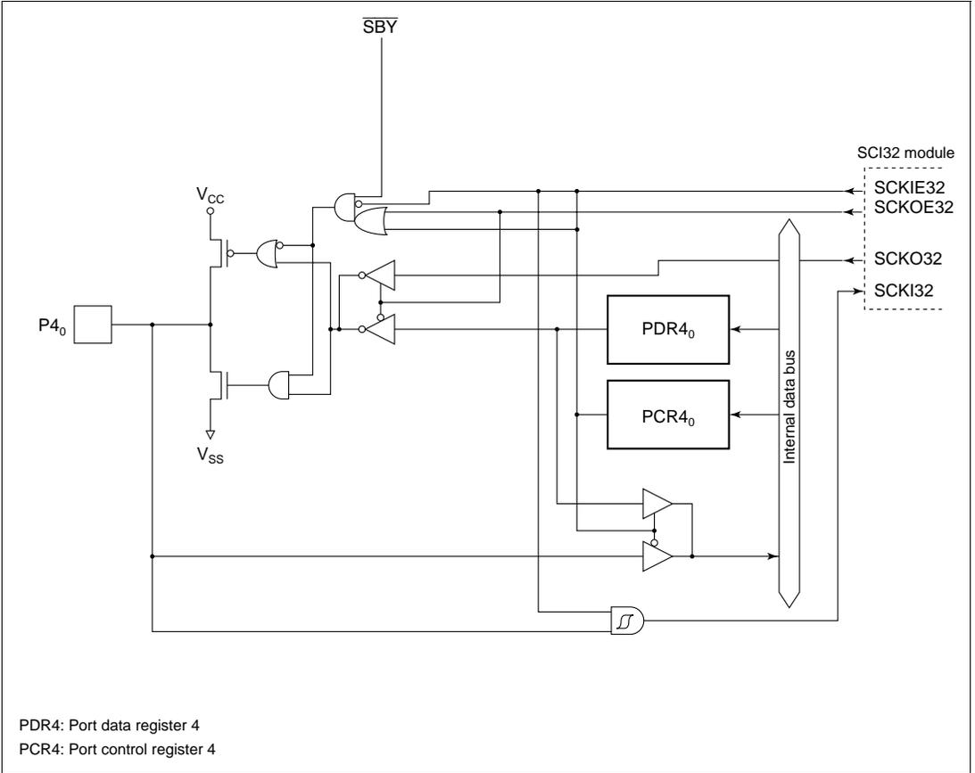
**Figure C.3 (d) Port 4 Block Diagram (Pin P4<sub>0</sub>)**
