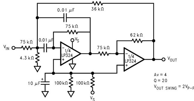
Figure 28. Band-Reject Filter
