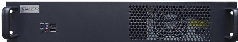
**TRASSIR NeuroStation 8400R/32-S** – сетевой видеорегистратор для IP-видеокамер под управлением TRASSIR OS (Linux) и с поддержкой видеоналитики на основе нейронных сетей: детекция проникновения людей в зону, подсчет количества людей в зоне (например, в очереди), а также поиск в архиве по людям<sup>1</sup>. Поддержка Offload-аналитики (прием и обработка изображений передаваемых с других серверов TRASSIR)
