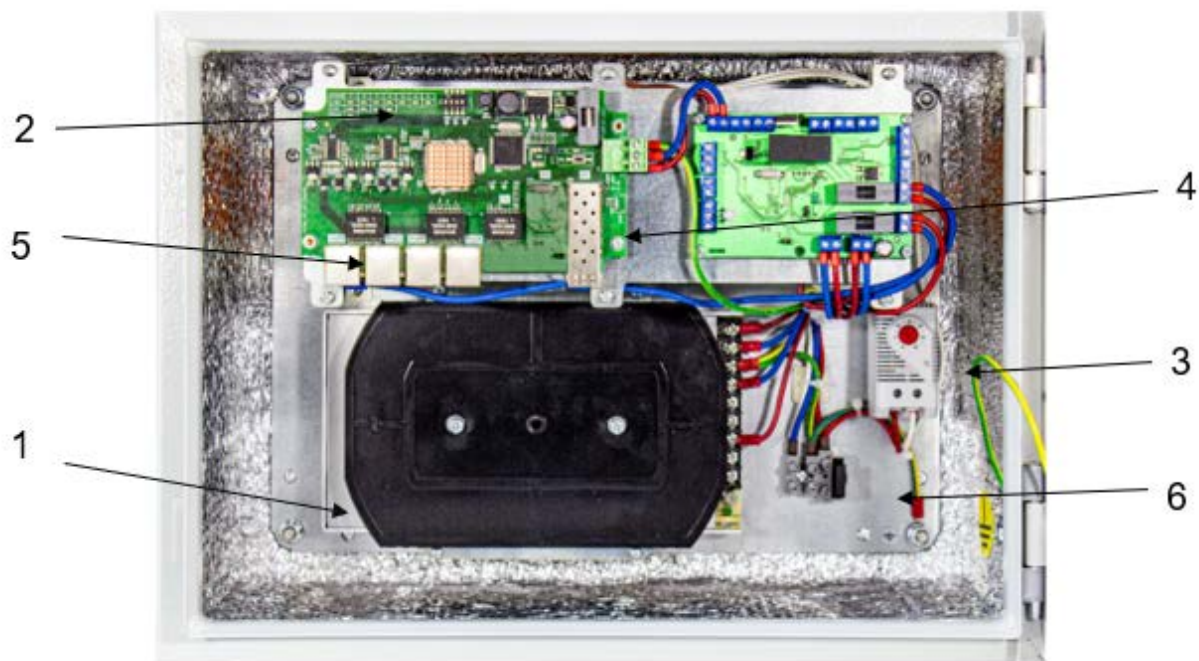
Рис. 6. Расположение составных частей Релион-SW-M-2G-4Poe+/60W
