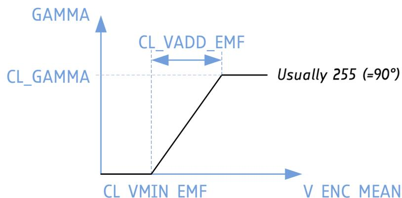
Figure 69: Calculation of the actual Load Angle GAMMA
