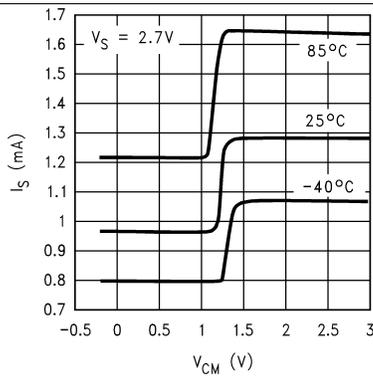
Figure 9. I<sub>S</sub> vs. V<sub>CM</sub>
