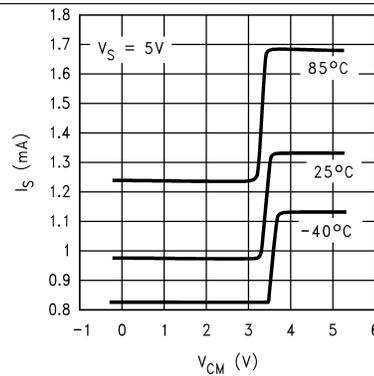
Figure 10. I<sub>S</sub> vs. V<sub>CM</sub>
