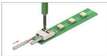
Кабель с многопроводной жилой вставляется после нажатия на фиксатор клеммы.
