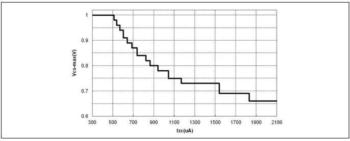
Figure 8 V<sub>CS\_max</sub> versus I<sub>zc</sub>
