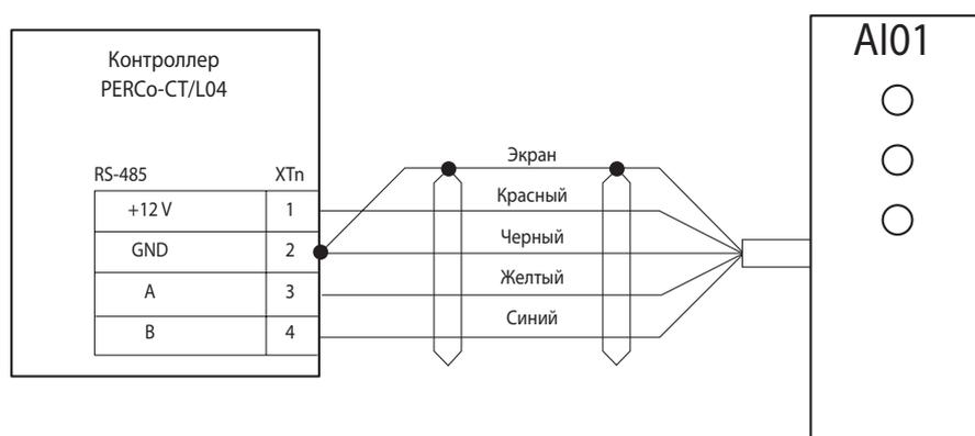
На рисунке указаны цвета жил кабеля, выходящего из блока индикации (длина кабеля при поставке 0,8 м). Удлинение кабеля производится кабелем с витыми парами, при этом сигнальные линии А и В (интерфейс RS-485) должны идти в одной паре.
